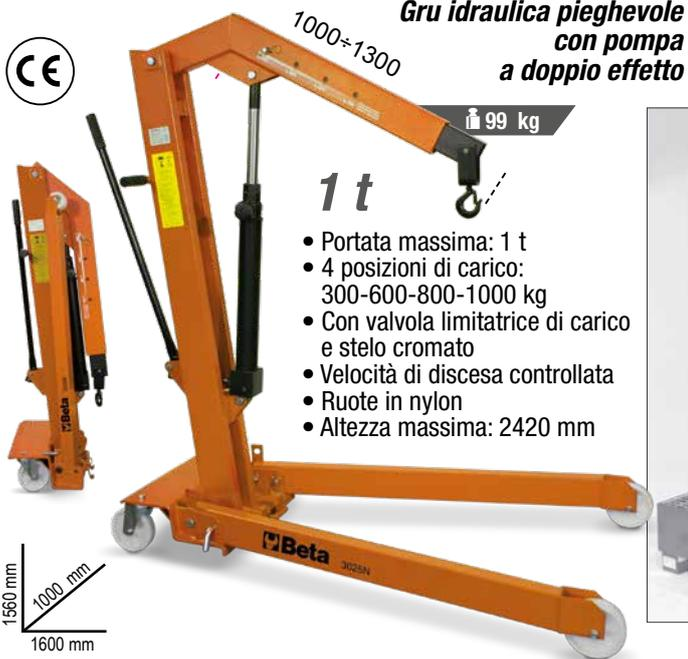
**Gru idraulica pieghevole con pompa a doppio effetto**
