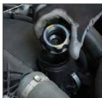
L'abbinamento di questi adattatori con l'imbuto 1758B, permette di immettere agevolmente l'olio in tutti quei motori con il problema del riflusso, senza rischiare di sporcare il vano motore.
