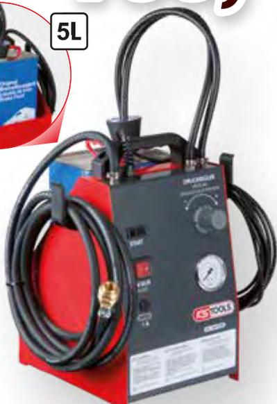
160.0700 Dispositivo per la manutenzione del circuito freni KS5
