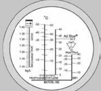
Rifrattometro - strumento ottico per il controllo del liquido batterie, del liquido antigelo e dell'additivo AdBlue®
