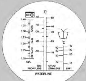
Rifrattometro - strumento ottico per il controllo del liquido batterie e del liquido antigelo
